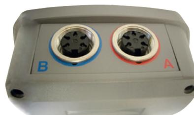
2 ports de connexion pour entrées de sonde de température
