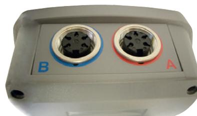
**2 porte di connessione per ingressi delle sonde di temperatura**
